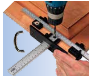
Voor het plaatsen van handvaten.
