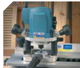
Door het blokkeersysteem ideaal om zwaluwstaartverbindingen te maken.
