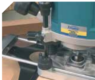
Zes aanpasbare posities voor snelle selectie van de freesdiepte.
