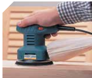
De machine combineert excentrische met ellips bewegingen.
