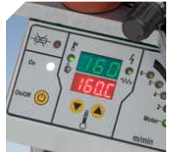
De instelling van de temperatuur (120 tot 200°C) wordt gecontroleerd door een microprocessor voor een grotere precisie bij de meting. De temperatuur gaat in stappen omhoog, wat het verwarmingselement beschermt en de levensduur hiervan verlengt.
