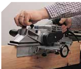
Micro-metrische geleider om onder hoek te schaven.
