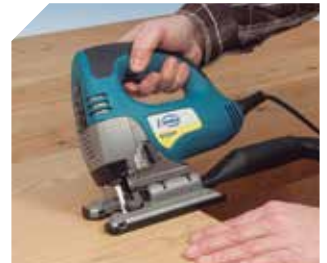
Basis kan gekanteld worden van 0° tot 45°
