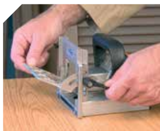
De hoek en hoogte kunnen ingesteld worden dmv een schaal.
