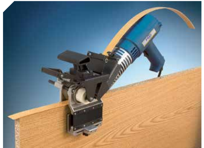
Voorgesneden bandjes tot 3 mm dikte en 25 mm breedte worden gelijmd met hoge precisie en kwaliteit.
