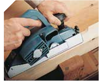
Speciaal ontworpen om hoeken af te schaven.
