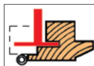
Sleuven in raam frezen, scharnierkant.
