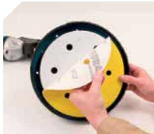
Sterke schuurplaat met velcro systeem.
