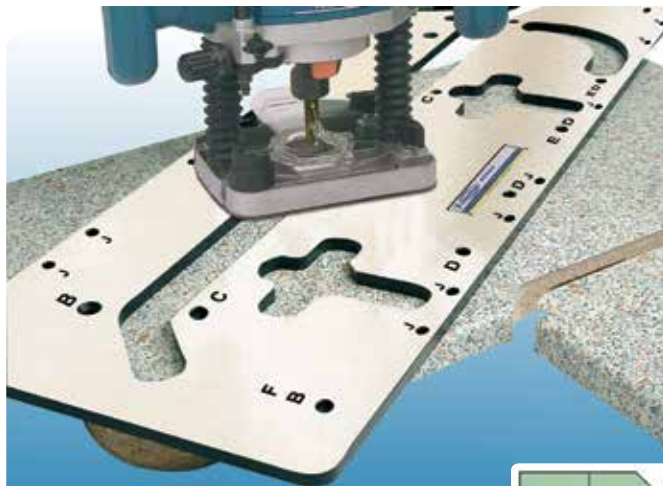
Kruisvorm infrezen voor beide zijden werkblad te verbinden.
