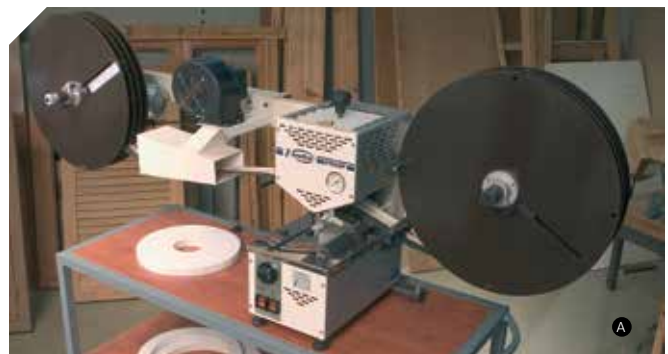
Makkelijke toegang tot de lijm bak. Het aanvoersysteem is voorzien van een siliconen roller waar de lijm niet blijft aankleven.
