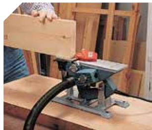
Basis om de machine stationair te gebruiken, kan op een werkbank gemonteerd worden.
