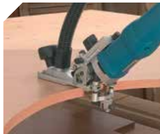
Copieur met kogellager, perfecte geleiding op rechte of gebogen oppervlakken.
