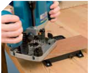
Bevestigen van kleine stukken op een verdeeld deel van de vacuümkleem.
