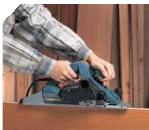
Schaafdiepte aanpassing met automatische gradaties van 0.2 mm.
