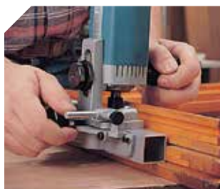
Sleuven in raam frezen, dagkant.
