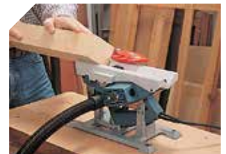
Basis om machine stationair te gebruiken.
