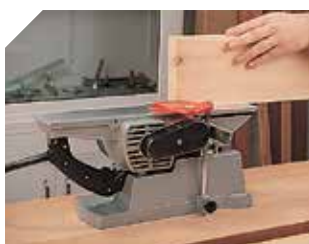
Basis om de machine stationair te gebruiken, kan op een werkbank gemonteerd worden.
