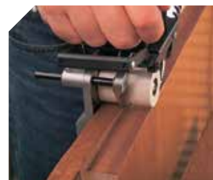
De bovenzijde van een rabat verlijmen
