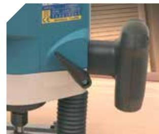
Hendel om de freeskop te blokkeren, bereikbaar van het handvat.
