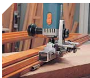
Sleuven in raam frezen, scharnierkant.
