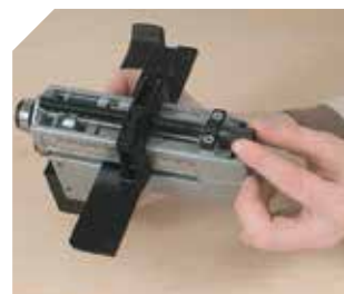
Micrometrische regeling van de snijbreedte
