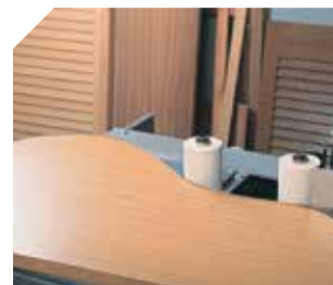
Handig voor het verlijmen van bandjes op gebogen werkstukken
