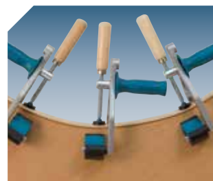
Fixeren van bandjes op holle panelen.
