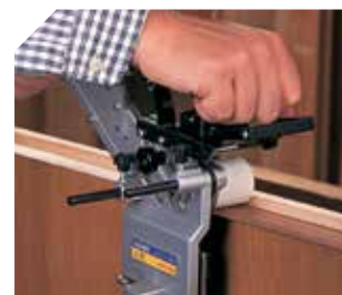
De binnenzijde van een rabat verlijmen
