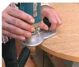
Heel makkelijk kanten affrezen van zowel rechte als gevormde panelen.
