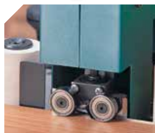
Krachtige kantensnijder: Trimmen van boven en onderkant van het werkstuk tegelijkertijd.
