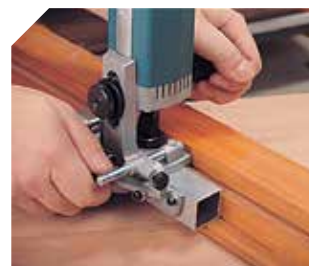
Sleuven in raam frezen, slotkant
