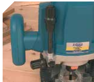
6 regelbare diepteposities om snel de gewenste freesdiepte in te stellen.
