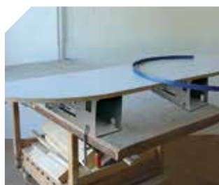
Door twee vacuümtafels te gebruiken is het mogelijk grote panelen te bewerken.
