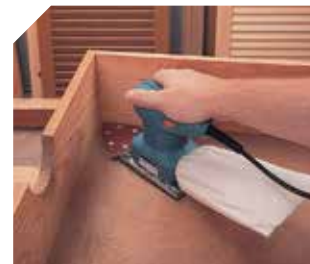
In hoeken schuren dmv de driehoekige basis.
