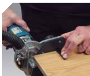
De vacuümaansluiting is voorzien van een rem.
