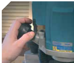
Aan/uit switch en blokkeerder kunnen bediend worden vanaf de handgreep, wat een veilige controle over de machine geeft.
