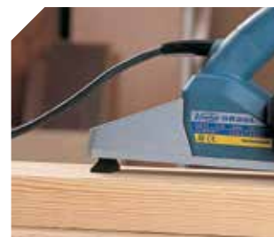
Rustpunt om te voorkomen dat de messen het werkstuk raken en beschadigen.
