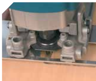
Geleidingsring om te kopiëren met een mal.
