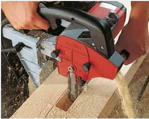
Pengaten met de LS 103 Ec in verschillende afmetingen tot 100 mm.
