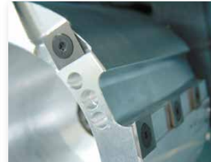
De nieuwe freeskop met hardmetalenkeermessen voor extreem verspanen met een optimale spaanafvoer.
